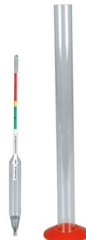
Ilustración 1. Ejemplo de un calostrómetro y la escala de calidad del calostro.
